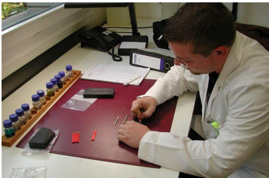
*Examen du titre d'ouvrages en métaux précieux : lors de l'essai à la pierre de touche, l'objet à examiner est comparé avec un alliage de référence. Les traits déposés sur la pierre sont attaqués par un acide, puis séchés avec un buvard. L'essayeur expérimenté voit ensuite clairement les différences de titres.*
